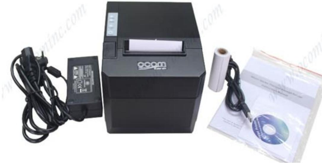
Para instalar la impresora térmica a un equipo debemos conectar la misma a la corriente eléctrica o al PC mediante el cable USB. Podemos utilizar el CD para instalar los drivers o descargarlos directamente desde la web del fabricante si no contamos con lectora en el dispositivo. Se detallan a continuación los pasos para instalar los drivers a partir del CD.
